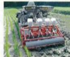
他の作業機との複合作業が可能。 (写真は施肥機サンソーとの同時作業)
